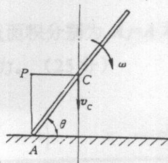
5. 下图所示为一无重刚杆, 其一端铰支, 距铰支端  $l$  处有一质量为  $m$  的质点, 距  $2l$  处有一阻尼器, 其阻尼系数为  $c$ , 距  $3l$  处有一刚度为  $k$  的弹簧, 并作用一简谐激振力  $F = F_0 \sin \omega t$ , 刚杆在水平位置平衡, 试列出系统的振动微分方程, 并求系统的无阻尼固有频率  $\omega_n$ , 以及当激振力频率  $\omega$  等于  $\omega_n$  时质点的振幅。(30 分)
