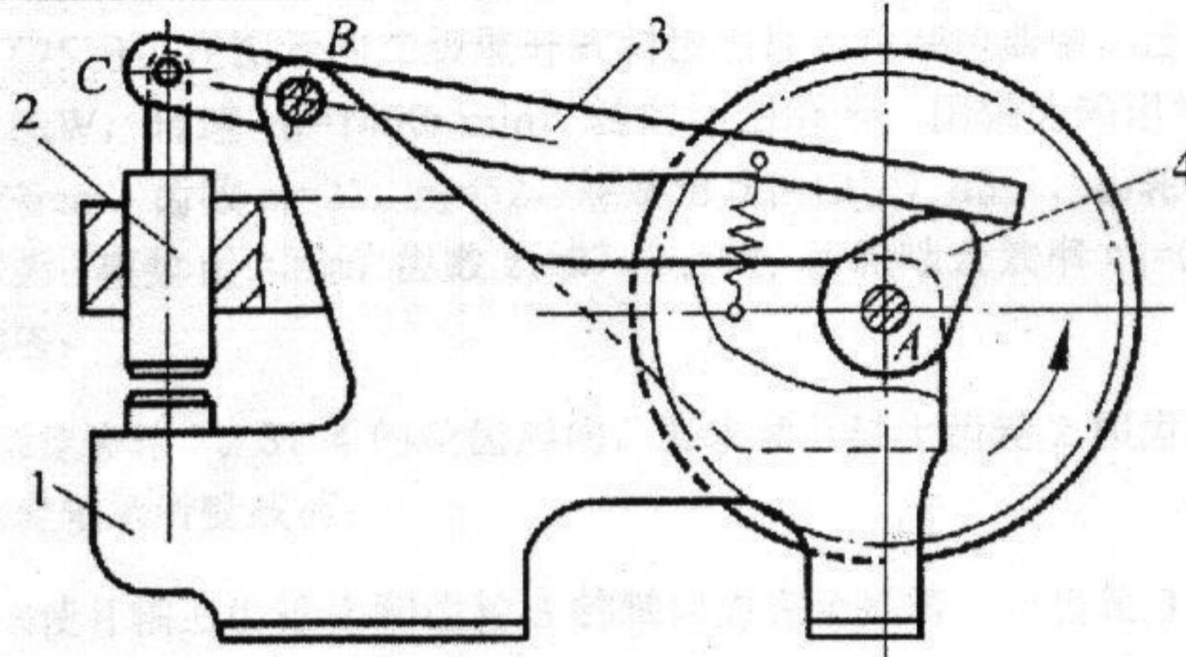
四、(20分)图示铰链四杆机构中,已知各杆长度为 $l_{AB}=20\text{mm}$ , $l_{BC}=60\text{mm}$ , $l_{CD}=85\text{mm}$ , $l_{AD}=50\text{mm}$ 。
