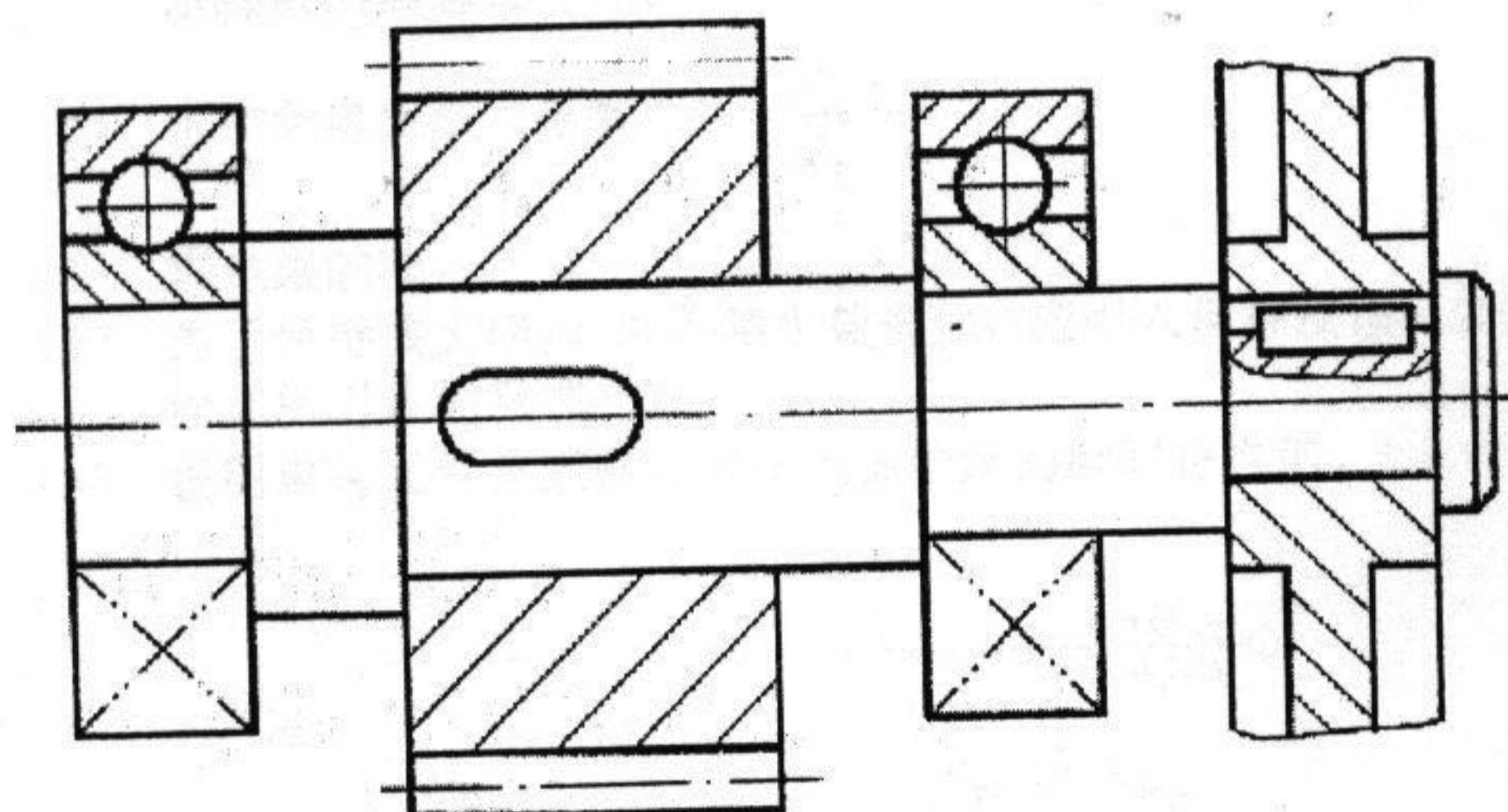
八、(25分) 在图示的二级展开式斜齿圆柱齿轮减速器中, 已知: I轴为输入轴, 输入功率  $P_1=10\text{ kW}$ , 转速  $n_1=1450\text{ r/min}$ , 转向如图所示, III轴为输出轴; 高速级齿轮参数为: 模数  $m_{n1}=3\text{ mm}$ , 齿数  $z_1=21$ ,  $z_2=52$ , 螺旋角  $\beta_1=12^\circ 7' 43''$ , 齿轮1的轮齿为右旋; 低速级齿轮参数为: 模数  $m_{n3}=5\text{ mm}$ , 齿数  $z_3=27$ ,  $z_4=54$ ; 齿轮啮合效率  $\eta_1=0.98$ , 滚动轴承效率  $\eta_2=0.99$ 。试解答:
