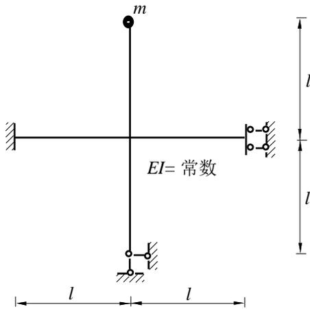
8、试用先处理法建立图示梁的结构总刚度矩阵  $[K]$ 。(20分)
