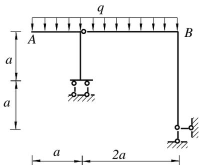
3、用力法作图示结构的  $M$  图,  $q = 12\text{kN/m}$ , 支座 B 竖向沉陷  $\Delta = 0.03\text{m}$ ,  $EI = 3.6 \times 10^4 \text{kN} \cdot \text{m}^2$ ,  $l = 4\text{m}$ 。(15 分)
