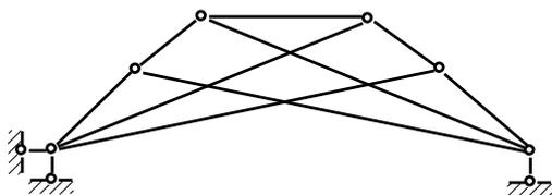
2、计算图示结构 B 点的水平位移,  $EI = \text{常数}$ 。(20 分)
