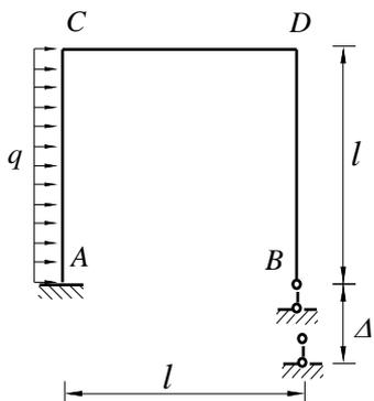
7、试求图示结构的自振频率。(15分)
