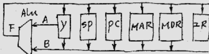
写出转移指令(JSR)的取指和执行的微操作序列。JSR指令占两个字,第一个字是操作码,第二个为子程序的起始地址。返回地址保存在存储器堆栈中,堆栈指针SP始终指向栈顶。图中Y为暂存器、PC为程序计数器, MAR与MDR分别为存储器地址与数据寄存器,ZR为指令寄存器。(10分)
