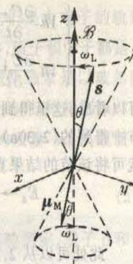
图 2-15 自旋磁矩的拉莫旋进
