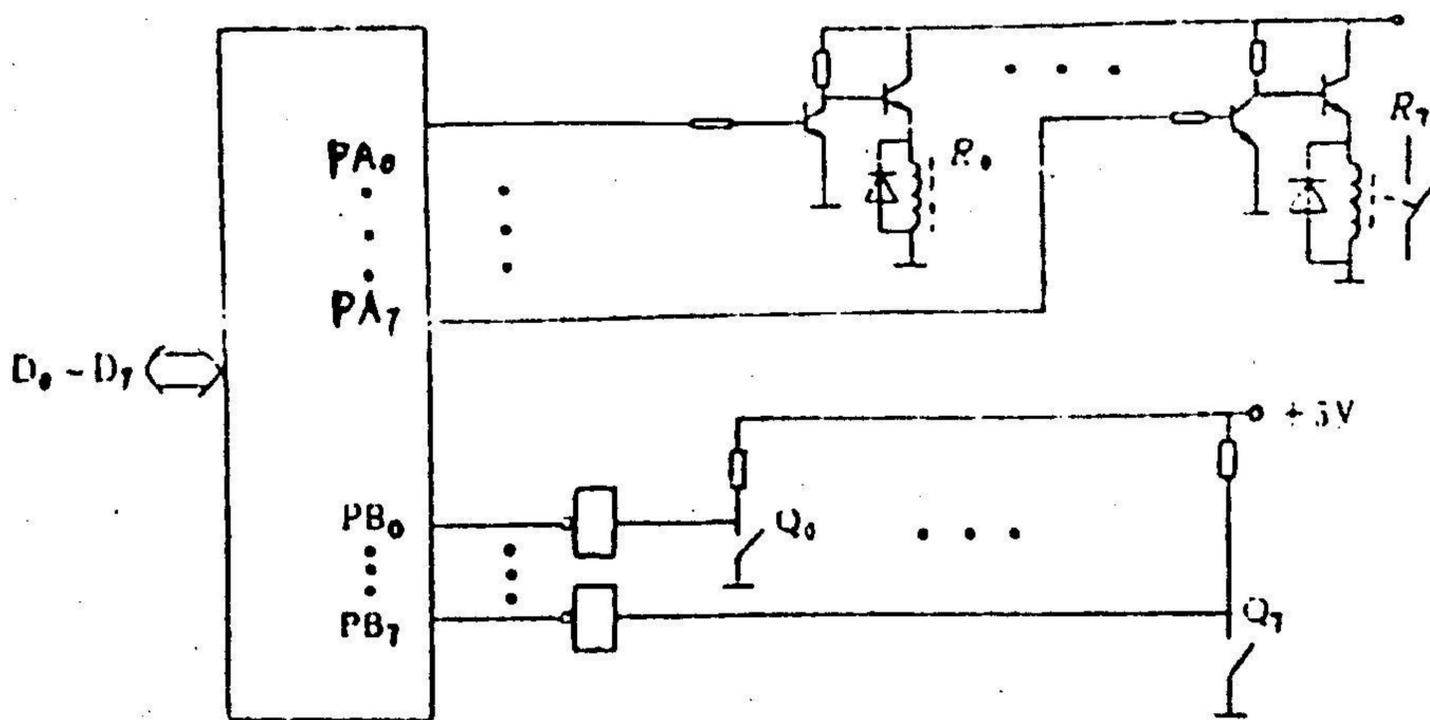
2. 下图是一简单的温度控制系统，从输出口 B 引出一根线 PB0 通过双位开关和加热器相连，加热时输出逻辑“1”。控制策略是：当 A/D 转换数据高于设定温度时断开，低于设定温度时加热。断开和加热过程均需要有 2 分钟的延时。温度设定值放在 VALUE 单元中。
