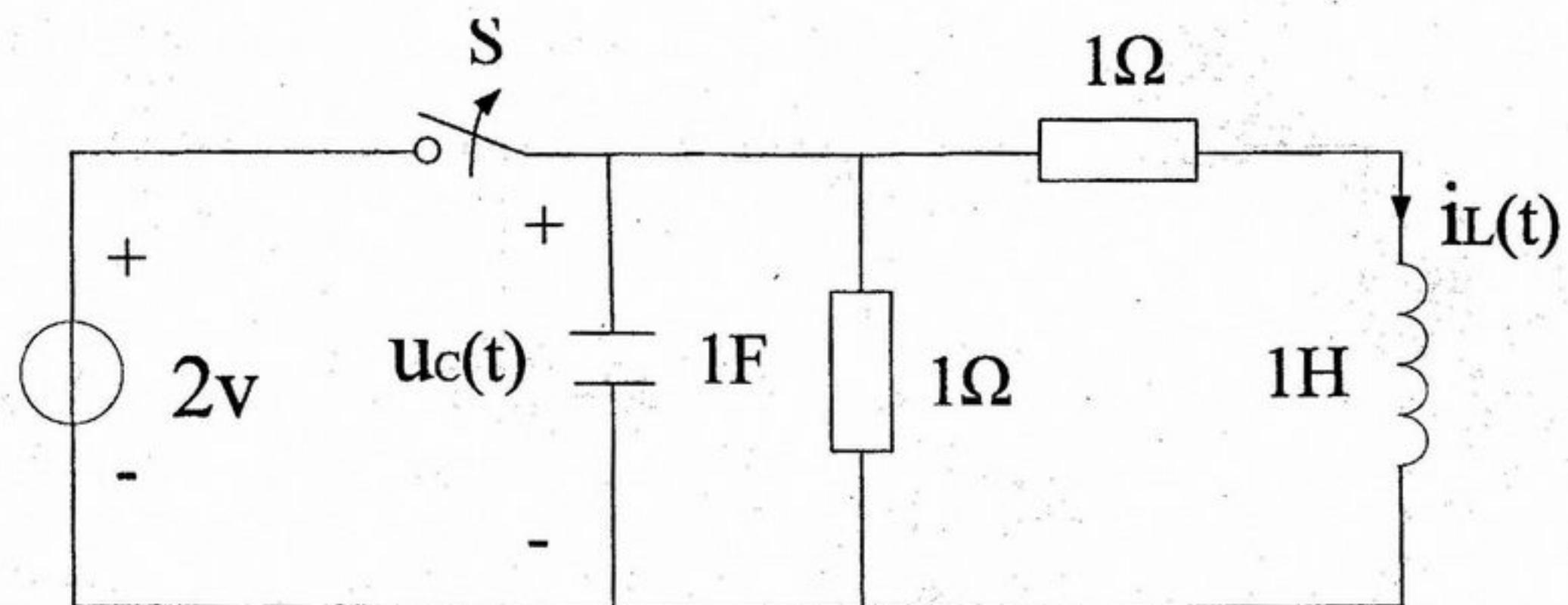
八、图示电路  $R=0.5\Omega$ ,  $L=1H$ ,  $C=1F$ ,  $\alpha=0.25$ , 求: (1) 网络函数  $H(s) = \frac{I_2(s)}{U_s(s)}$
