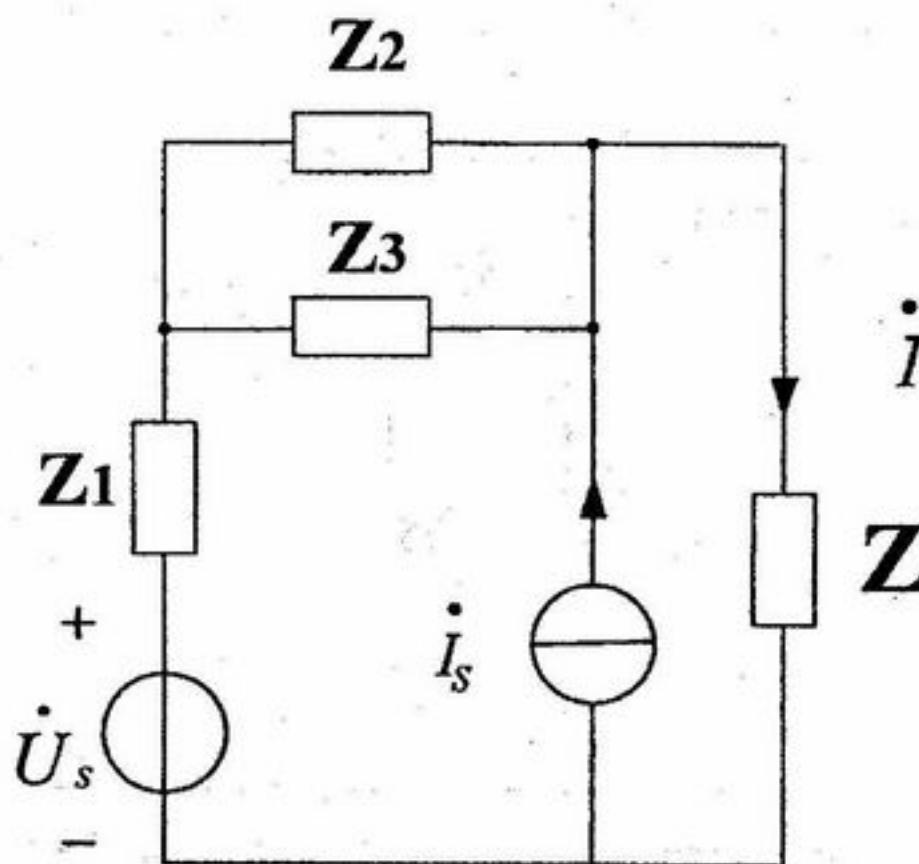
四、图示电路, 已知  $R_1 = R_2 = 10\Omega$ ,  $\frac{1}{\omega C} = 50\Omega$ ,  $\dot{U}_s = 50\angle 0^\circ V$ . 求  $\dot{I}=?$  (15 分)
