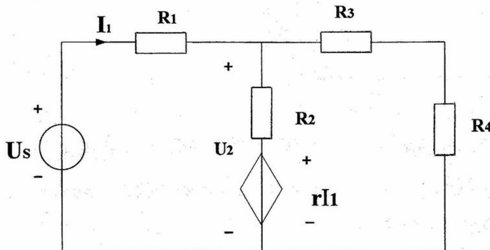
二、已知  $R_L = 3.6\Omega$  时获得最大功率，求此时  $R_x = ?$   $P_{L\max} = ?$  (15 分)
