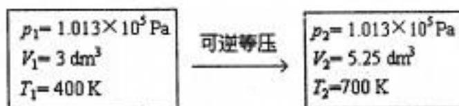
此体系的  $C_p = 20 \text{ J} \cdot \text{K}^{-1}$ , 始态熵  $S_1 = 30 \text{ J} \cdot \text{K}^{-1}$ 。计算过程的  $Q$ ,  $W$  及体系的  $\Delta U$ ,  $\Delta H$ ,  $\Delta S$ ,  $\Delta F$ ,  $\Delta G$  的值。
