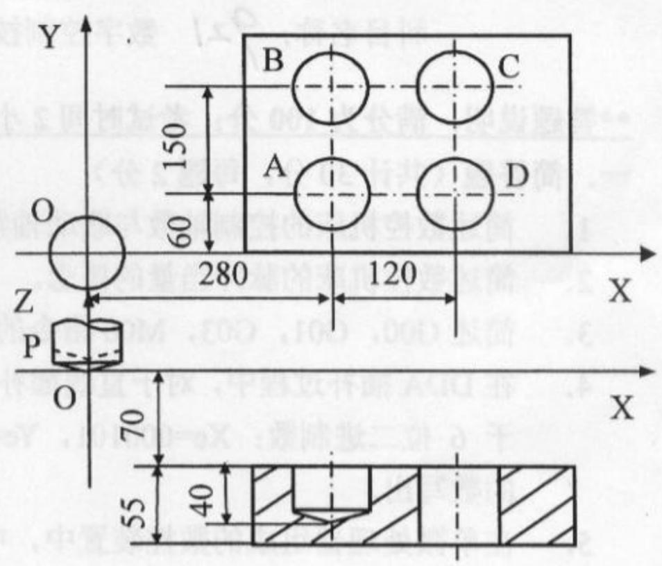
2. (15分) 编写如图所示零件的车削加工程序, 该零件要进行精加工, 其中直径120mm的外圆不加工, A点为起刀点, 主轴转速选择S31, 进给速度选择F15。
