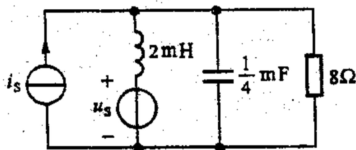
九, (15分) 图示电路中, 已知电压源电压  $u_s(t)=100\sqrt{2} \cos 1000t$  V,  $i_s(t)=10\sqrt{2} \sin(1000t+90^\circ)$  A。试求电流  $i_1(t)$ 。
