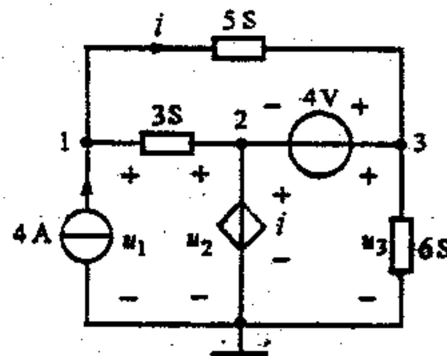
二、(15分)列出图示电路的网孔方程，计算出三个网孔电流。
